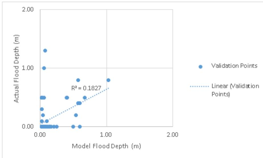
Figure 90. Flood map depth vs actual flood depth
