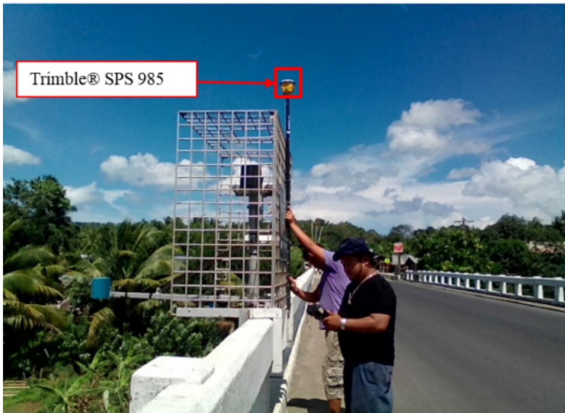
Figure 34. Acquisition of AWLS sensor elevation at Kibungsod Bridge, Brgy. Kibungsod, Magsaysay, Misamis Oriental
