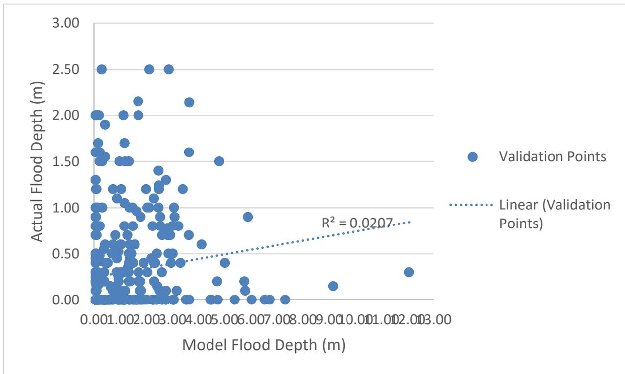
Figure 97. Flood map depth vs actual flood depth
