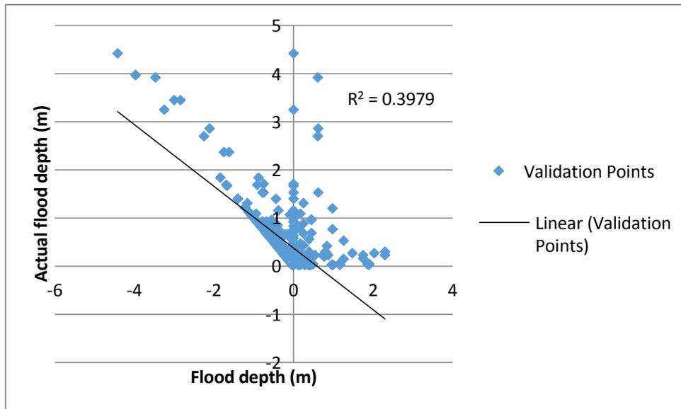
Figure 80. Flood map depth vs actual flood depth
