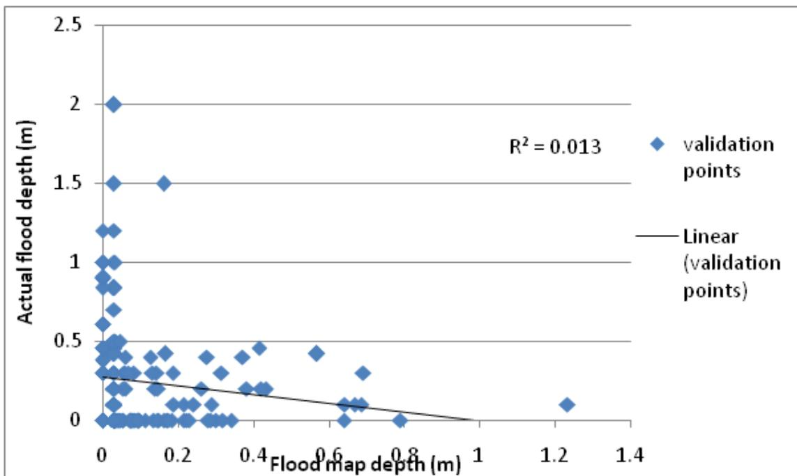
Figure 85. Flood map depth vs actual flood depth
