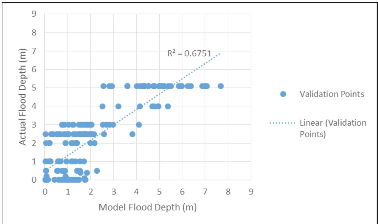
Figure 81. Flood map depth vs. actual flood depth
