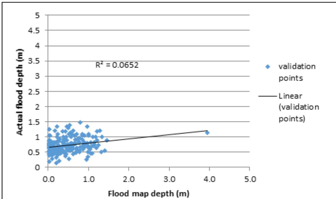
Figure 82. Flood map depth vs actual flood depth
