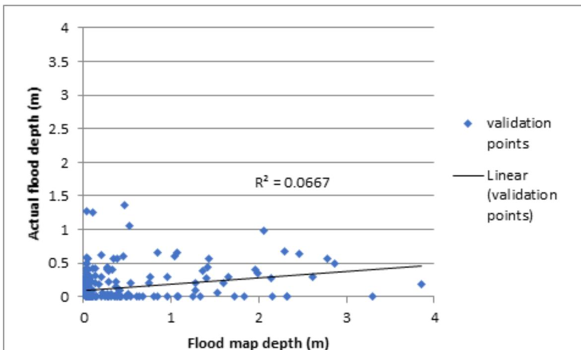
Figure 84. Flood map depth vs actual flood depth
