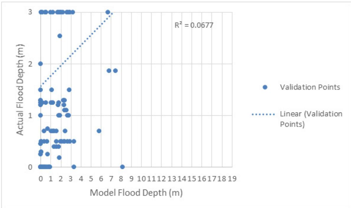
Figure 106. Flood map depth vs actual flood depth
