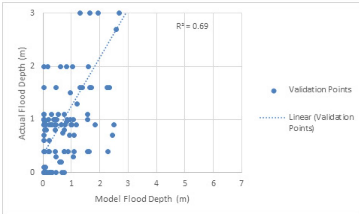
Figure 94. Flood map depth vs. actual flood depth
