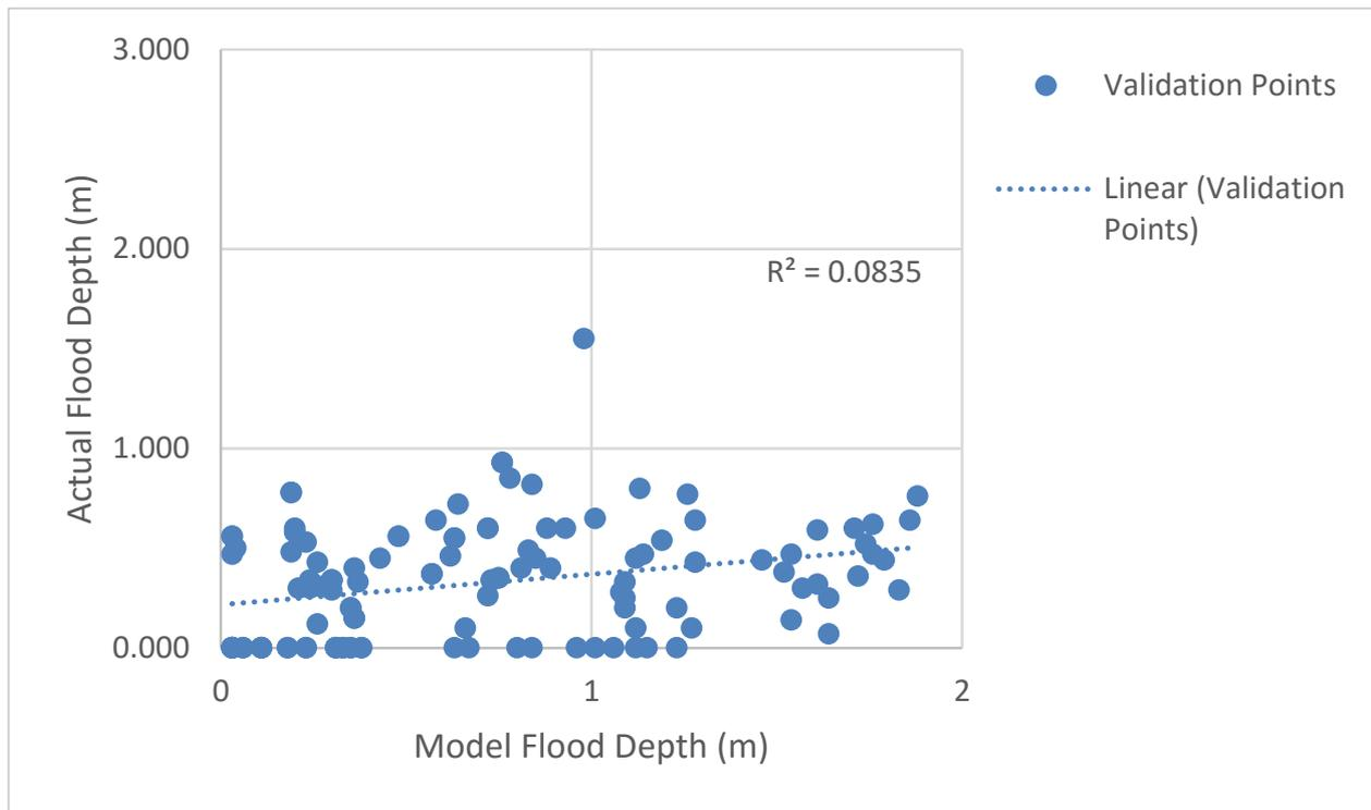
Figure 77. Flood map depth vs actual flood depth.
