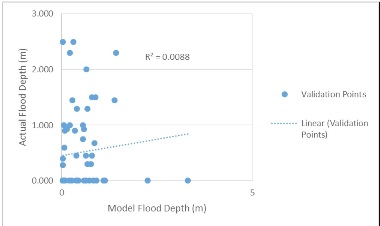
Figure 74. Flood map depth vs. actual flood depth
