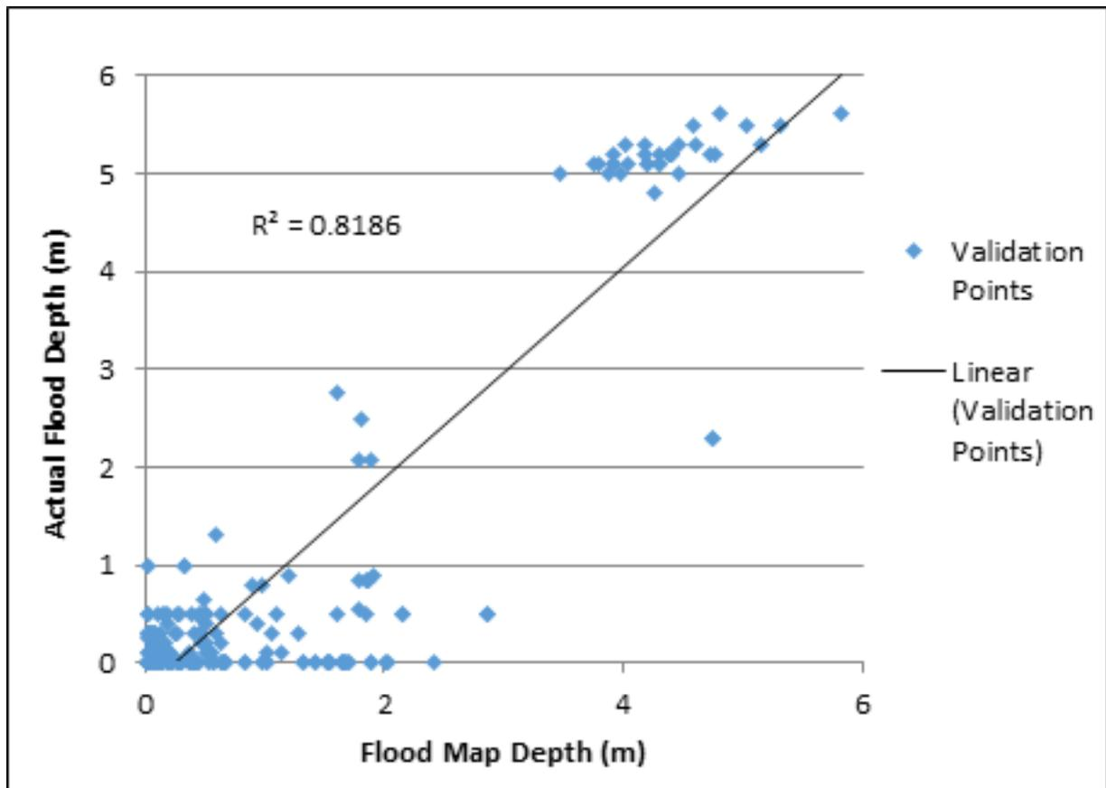
Figure 78. Flood map depth vs actual flood depth
