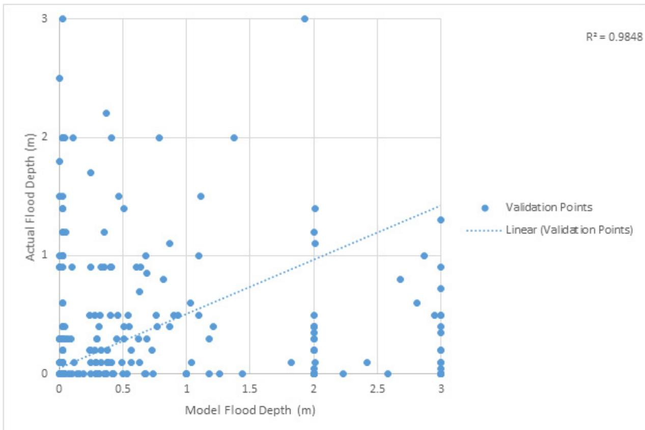
Figure 84. Flood map depth vs. actual flood depth
