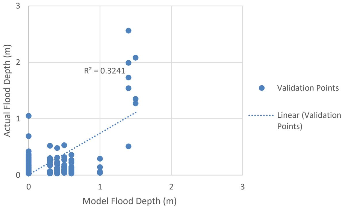
Figure 107. Flood map depth vs actual flood depth
